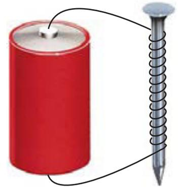
**Figura 12-9** Se puede construir un electroimán muy sencillo con un clavo y un poco de cable.
